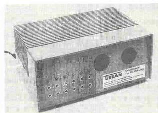
Das Ladegerät Titan 622 von Pein verfügt über eine eingebaute Schaltuhr (bis 16 Stunden), fünf Konstantstromausgänge mit einem festen Ausgangsstrom sowie einen Ausgang mit vorwählbarem Ladestrom.
